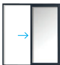
2 VANTAUX 2 RAILS largeur jusqu'à 3,20 m
