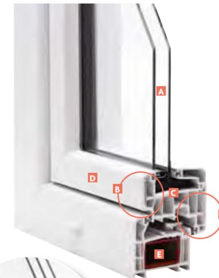
AVEC UN TRIPLE VITRAGE 4/12/4/12/4 ITR ARGON PERFORMANCES THERMIQUES : **Uw = 0.85 W/m².K** avec Ug de 0.5 + intercalaire composite
